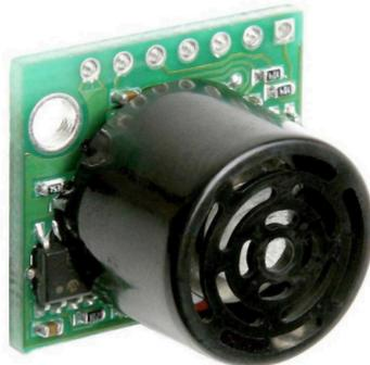
Figura 3.6: Sensor de distância ultra-sons LV-MaxSonar<sup>®</sup>-EZ0<sup>™</sup>.
